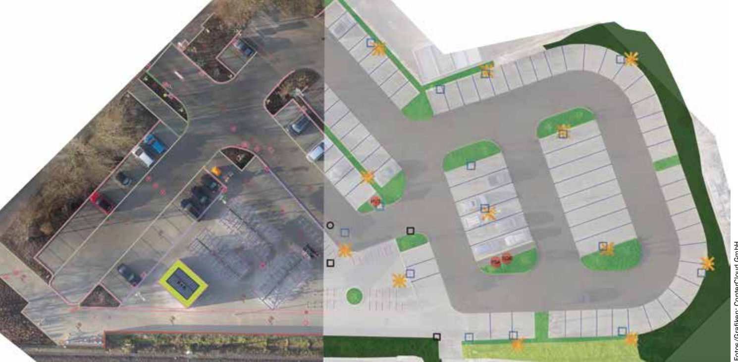
Projektbeispiel der P+R Betriebsgesellschaft in Hamburg: Im Hintergrund das verzerrungsfreie Orthofoto, links der Abgleich mit dem CAD-Lageplan, rechts das Flächenkataster
